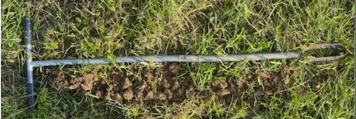
Figure 10 : photographie du sondage n° 1 des échantillons extraits du sol
