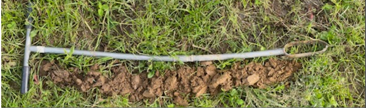
Figure 10 : photographie du sondage n° 4 des échantillons extraits du sol
