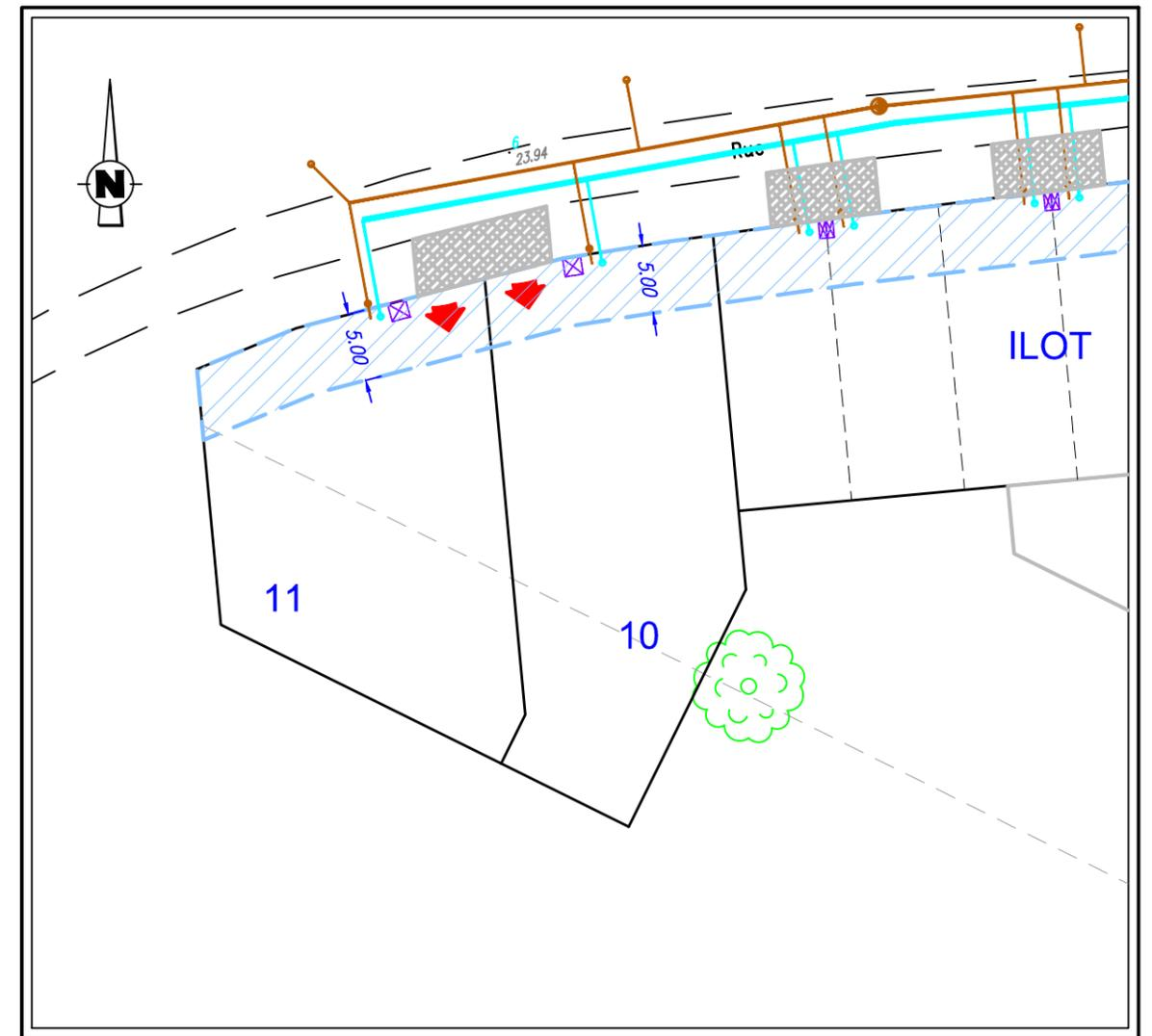
*NOTA : L'emplacement des branchements est figuratif et devra être vérifié avant tout projet de construction. L'adaptation de la construction au terrain sera étudiée en tenant compte des différents niveaux après travaux de viabilisation.*
