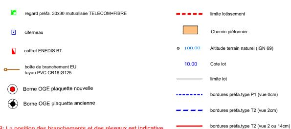
N.B: La position des branchements et des réseaux est indicative. Les cotes indiquées sur le plan sont indicatives.
