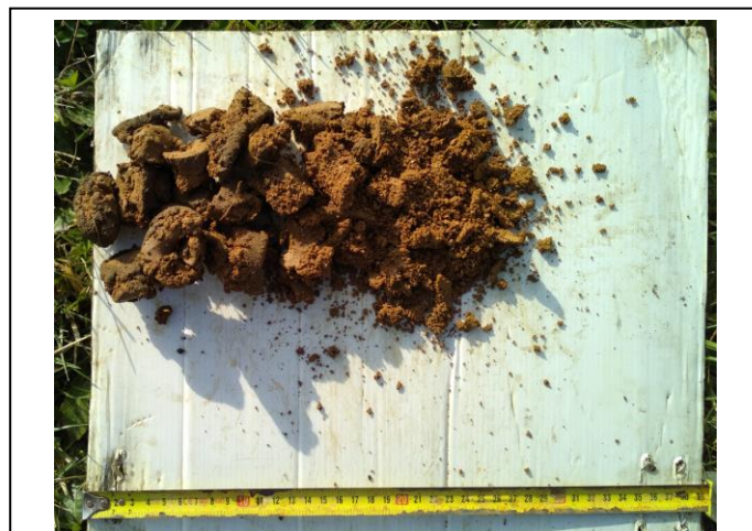
Photographie des prélèvements à la tarière T1 (faciès argilo-sableux et sablo-argileux)
