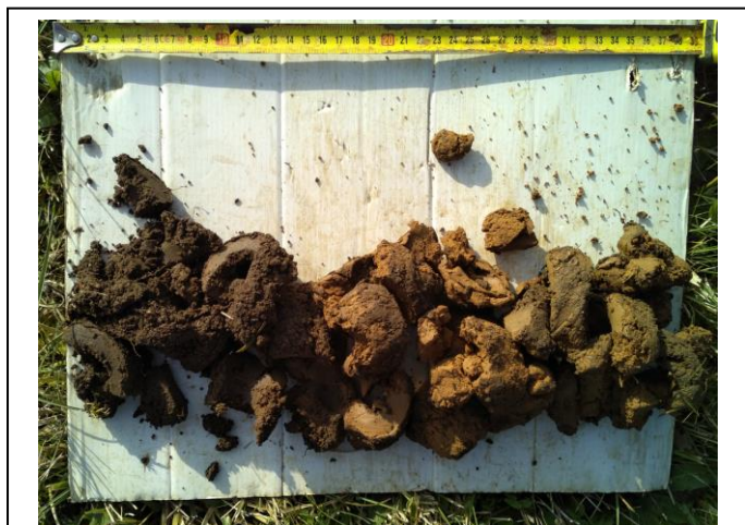
Photographie des prélèvements à la tarière T1 (faciès de terre végétale et d'argilo-sableux)
