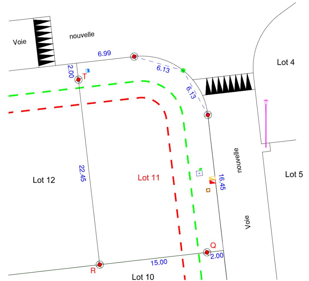
**N.B.:** L'emplacement des branchements et des réseaux est schématique.
