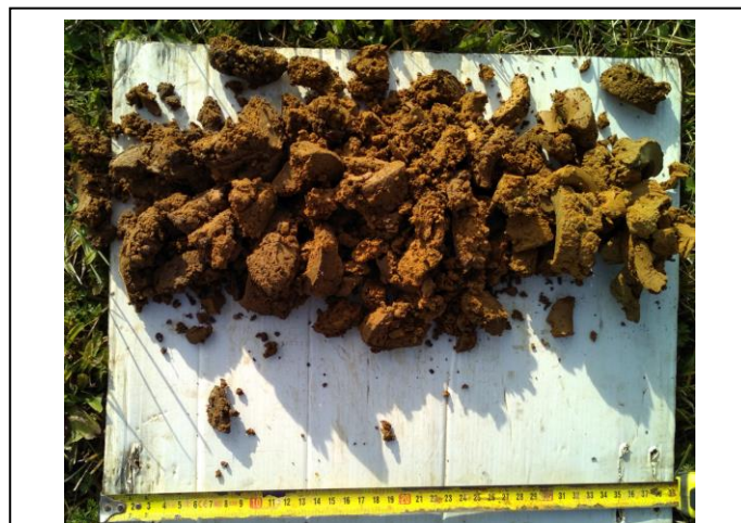
Photographie des prélèvements à la tarière T3 (faciès sablo-argileux et d'argile)
