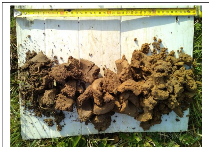
Photographie des prélèvements à la tarière T3 (faciès de terre végétale et d'argilo-sableux)
