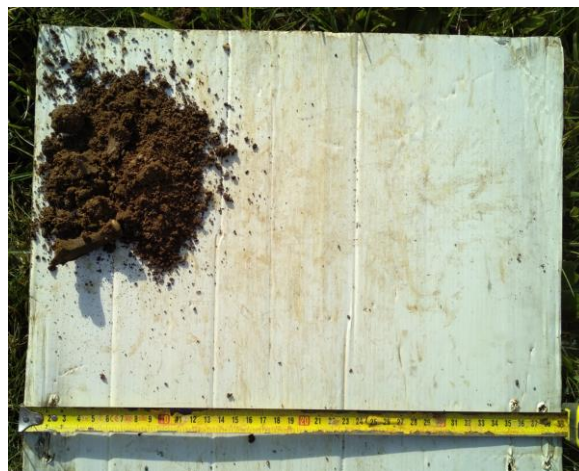
Photographie des prélèvements à la tarière T7 (faciès de sables moyens)
