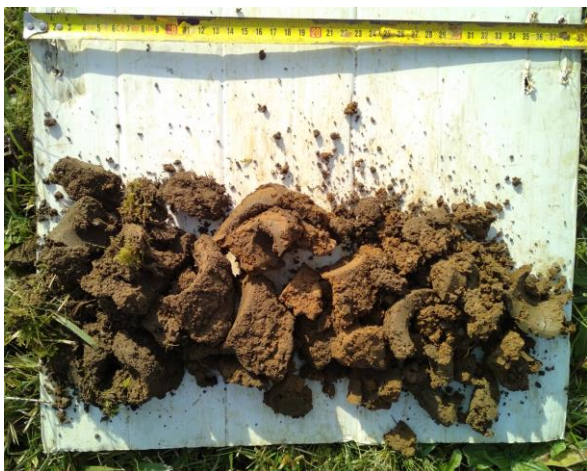
Photographie des prélèvements à la tarière T7 (faciès de terre végétale et d'argilo-sableux)
