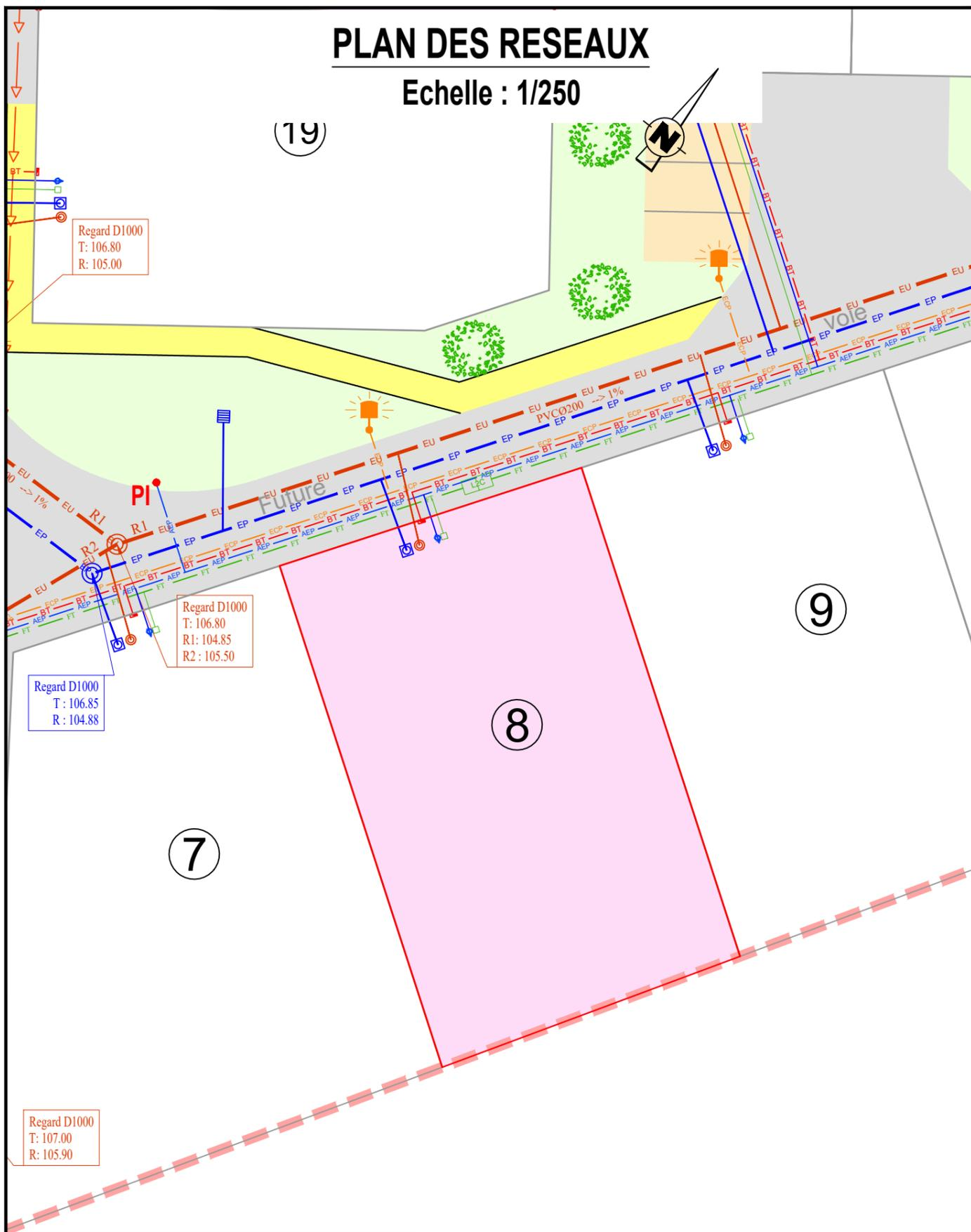
**Nota :** La position et la profondeur des branchements sont figuratives. Tout projet de construction devra tenir compte des positions et altimétries réelles après travaux de viabilisation. De plus, la position et l'altimétrie des éléments de viabilisation présents sur la voirie (tampons, grilles, candélabres...) sont figuratives et pourront être modifiés lors des travaux de viabilisation.
