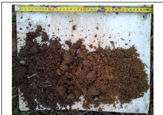
Photographie des prélèvements à la tarière T1 (faciès de terre végétale et de sables)
