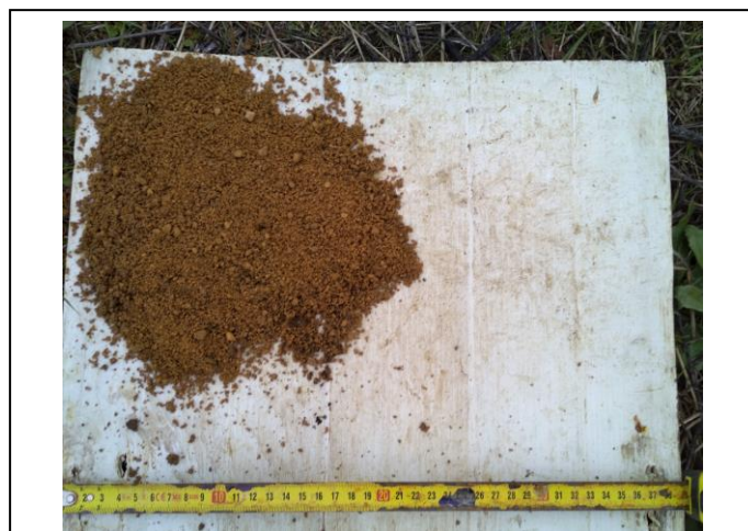
Photographie des prélèvements à la tarière T1 (faciès sableux)
