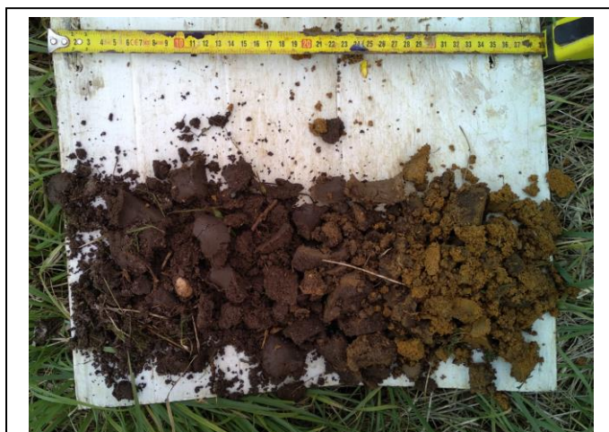
Photographie des prélèvements à la tarière T2 (faciès de terre végétale et de sables)
