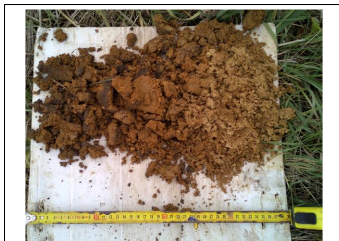
Photographie des prélèvements à la tarière T2 (faciès sableux)
