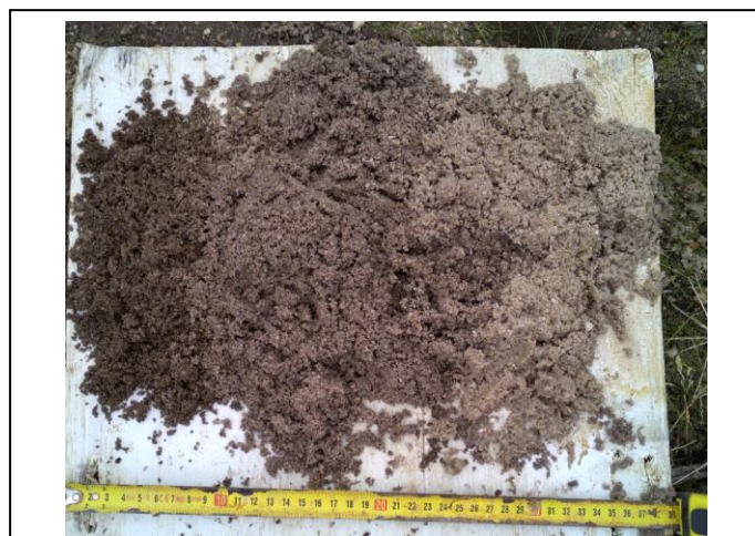
Photographie des prélèvements à la tarière T6 (faciès de limon sableux et de sables)
