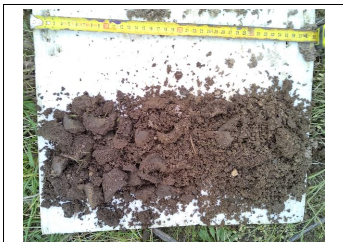
Photographie des prélèvements à la tarière T6 (faciès de terre végétale et de limon sableux)
