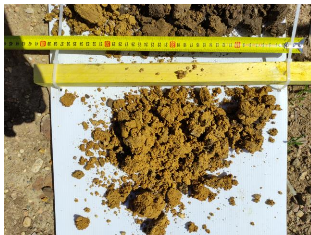
Photographie des prélèvements à la tarière T1 (faciès de calcaire marneux très altéré)
