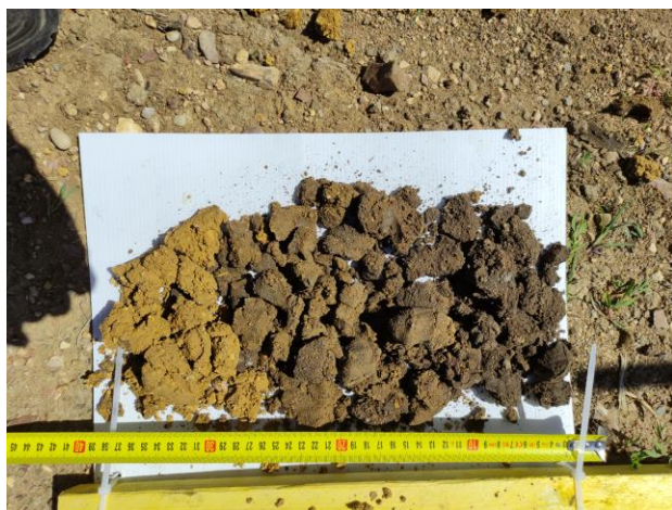
Photographie des prélèvements à la tarière T1 (faciès de limon marneux et de calcaire marneux très altéré)
