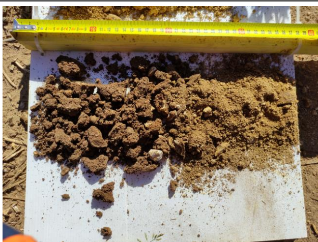
Photographie des prélèvements à la tarière T10 (faciès de limon marneux)
