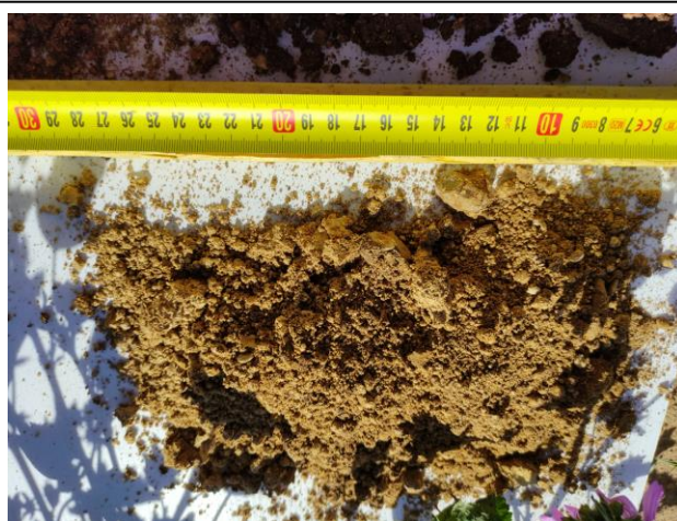
Photographie des prélèvements à la tarière T10 (faciès de limon marneux et faciès de calcaire marneux très altéré)
