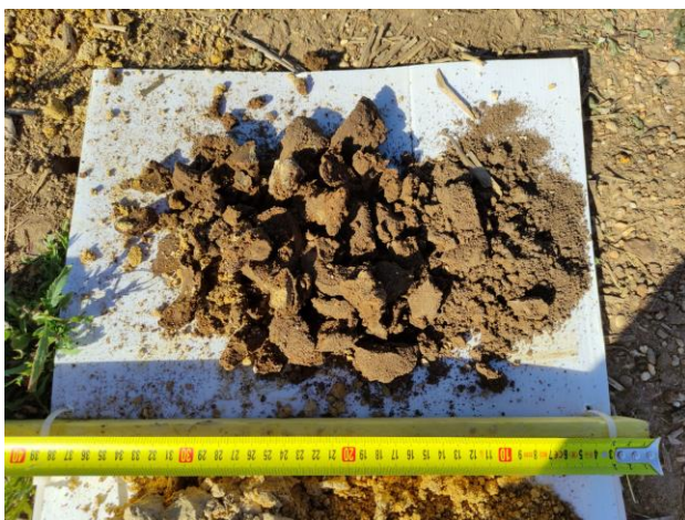
Photographie des prélèvements à la tarière T11 (faciès de limon marneux et de calcaire marneux très altéré)
