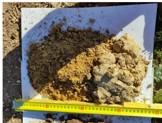
Photographie des prélèvements à la tarière T11 (faciès de calcaire marneux très altéré et de calcaire altéré)
