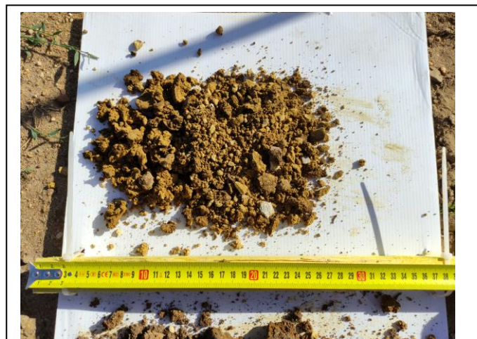
Photographie des prélèvements à la tarière T12 (faciès du calcaire altéré)
