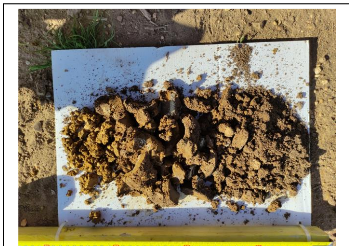
Photographie des prélèvements à la tarière T12 (faciès de limon sableux et limon marneux)
