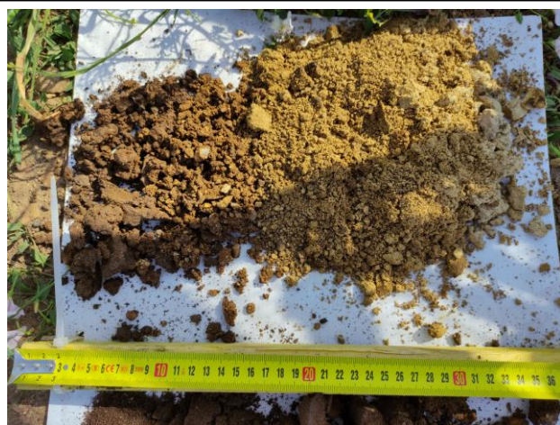
Photographie des prélèvements à la tarière T14 (faciès du calcaire marneux altéré et de calcaire altéré)
