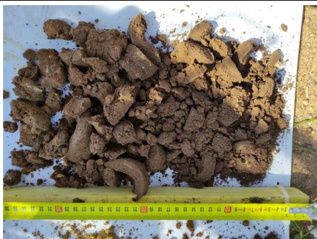
Photographie des prélèvements à la tarière T14 (faciès de limon marneux)
