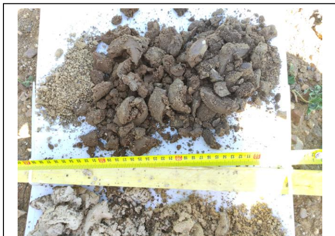
Photographie des prélèvements à la tarière T18 (faciès de limon marneux et de calcaire marneux)
