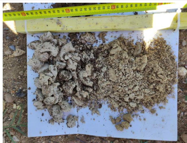
Photographie des prélèvements à la tarière T18 (faciès de calcaire marneux et de calcaire altéré)
