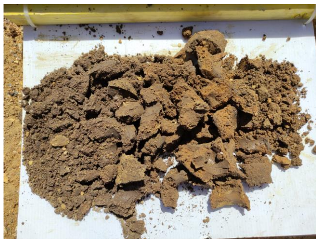
Photographie des prélèvements à la tarière T20 (faciès de limon sableux à alternance marneuse)
