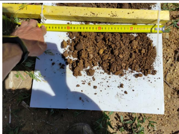
Photographie des prélèvements à la tarière T22 (faciès du calcaire altéré)
