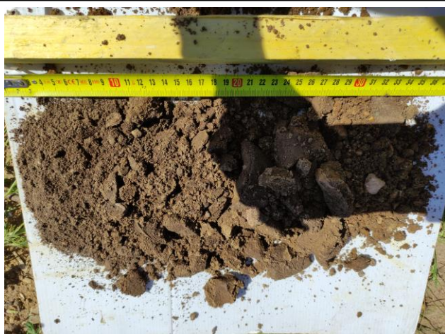
Photographie des prélèvements à la tarière T22 (faciès de limon sableux et limon marneux)
