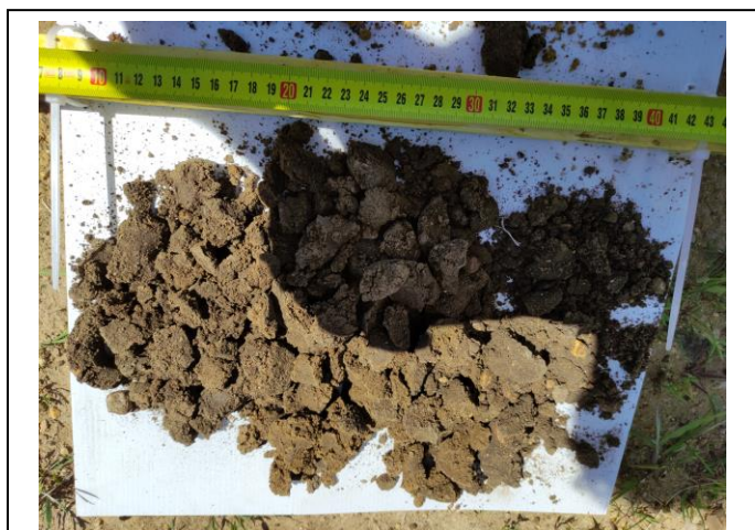
Photographie des prélèvements à la tarière T4 (faciès de limon marneux et de calcaire marneux très altéré)
