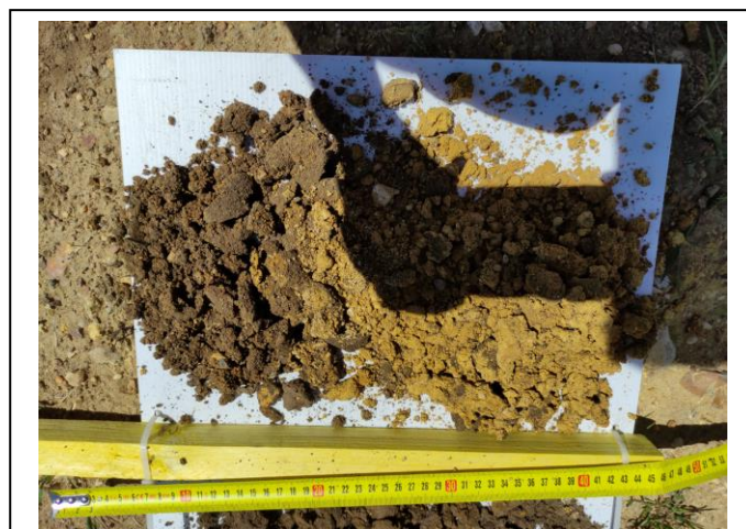
Photographie des prélèvements à la tarière T4 (faciès de calcaire marneux très altéré)
