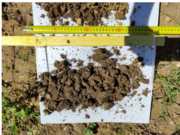
Photographie des prélèvements à la tarière T5 (faciès de limon marneux et de calcaire marneux très altéré)
