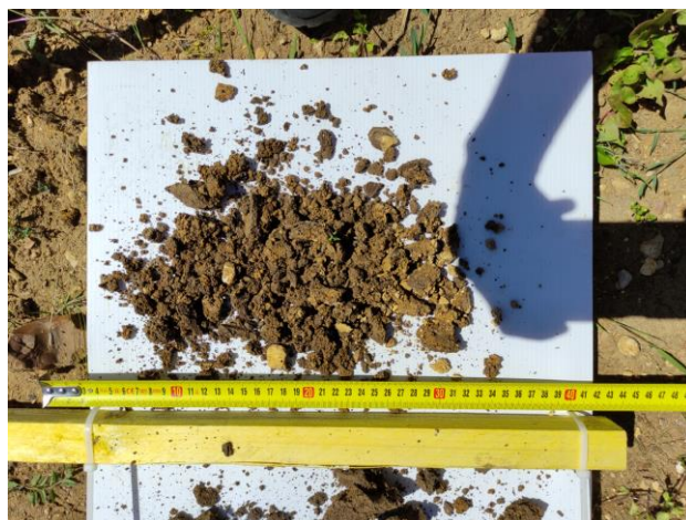
Photographie des prélèvements à la tarière T5 (faciès de calcaire marneux très altéré)
