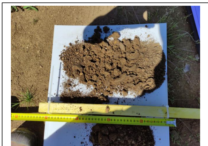
Photographie des prélèvements à la tarière T6 (faciès de limon marneux et de sables et graviers)
