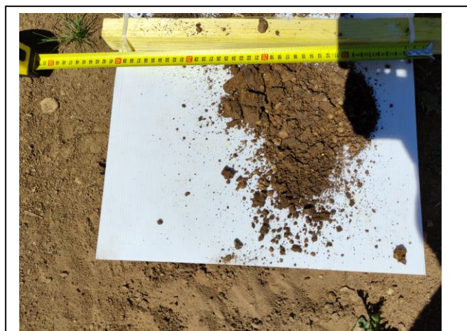
Photographie des prélèvements à la tarière T6 (faciès de sables et graviers)
