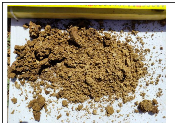
Photographie des prélèvements à la tarière T7 (faciès de calcaire marneux très altéré)
