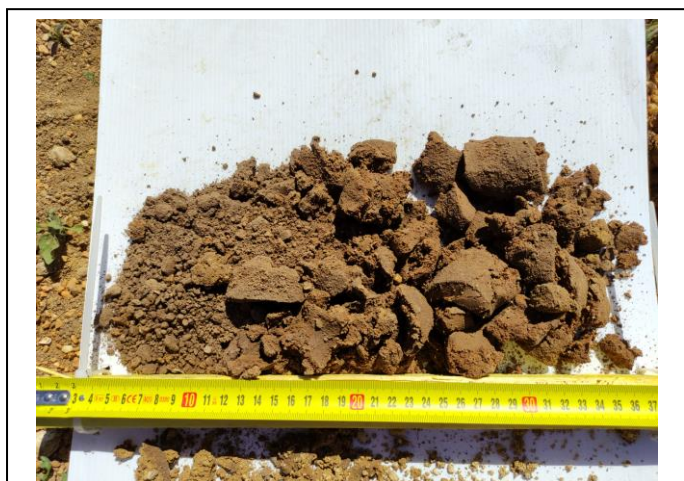
Photographie des prélèvements à la tarière T7 (faciès de limon marneux et de calcaire marneux très altéré)
