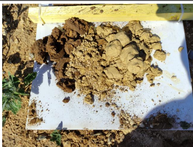
Photographie des prélèvements à la tarière T8 (faciès de limon marneux et faciès de calcaire marneux très altéré)
