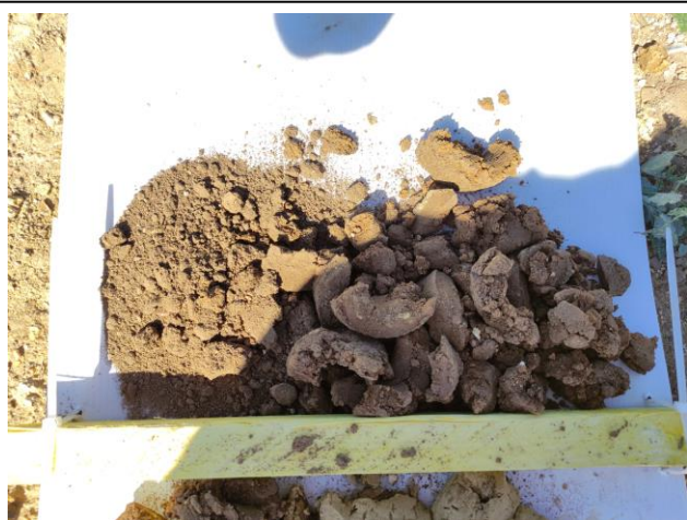
Photographie des prélèvements à la tarière T8 (faciès de limon marneux)
