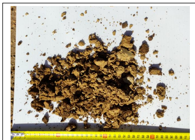
Photographie des prélèvements à la tarière T9 (faciès de limon marneux et faciès de calcaire marneux très altéré)
