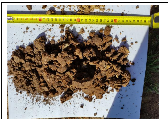
Photographie des prélèvements à la tarière T9 (faciès de limon marneux)
