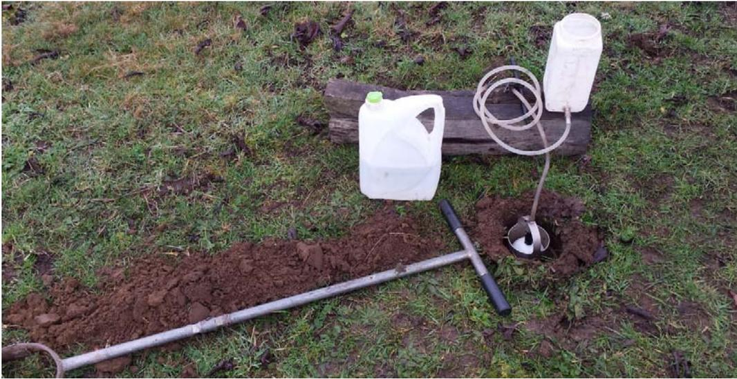
Les premières traces d'hydromorphie apparaissent localement sous la forme de concrétions ferriques dans l'horizon des limons bruns, soit vers 0.05 m en partie basse et vers 0.50 m en partie haute. Ces traces ne témoignent de l'engorgement du sol en période fortement pluvieuse, et donc de son imperméabilité en profondeur (les essais Matsuo ne sont donc pas nécessaires).
