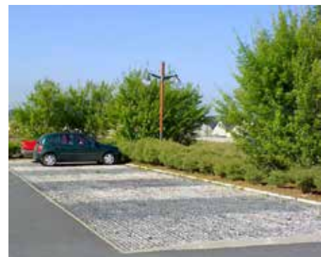
Exemple d'espaces de stationnement en matériaux perméables et poreux
