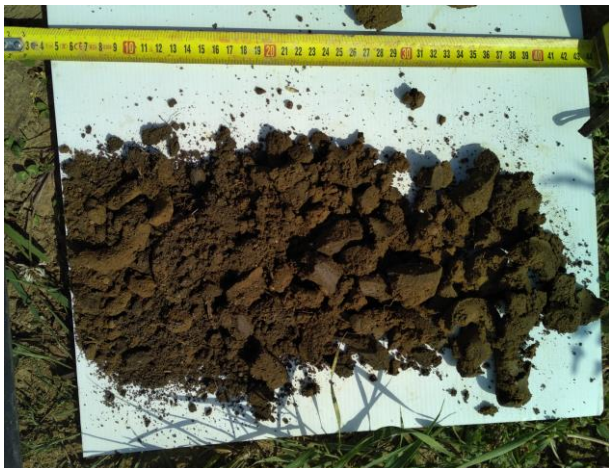
Photographie des prélèvements à la tarière T4 (faciès de limon argileux)
