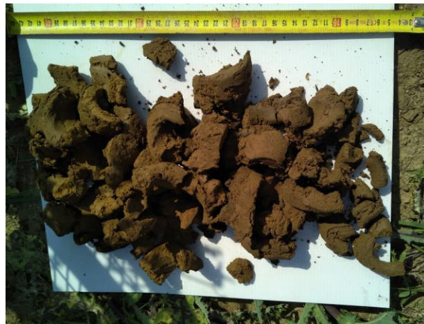
Photographie des prélèvements à la tarière T1 (faciès d'argile compact)
