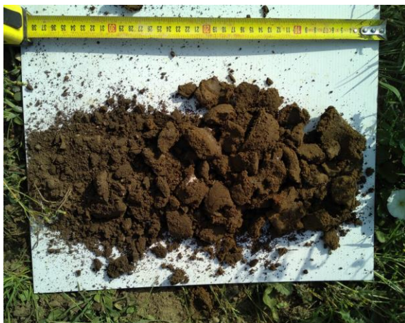
Photographie des prélèvements à la tarière T7 (faciès de limon argileux)
