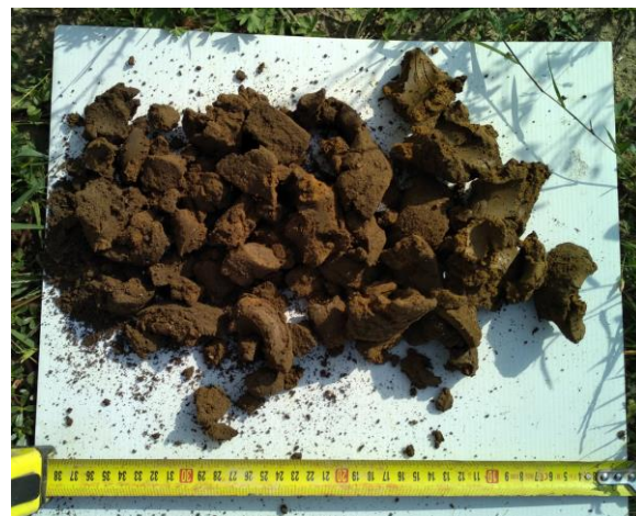
Photographie des prélèvements à la tarière T7 (faciès d'argile compact)
