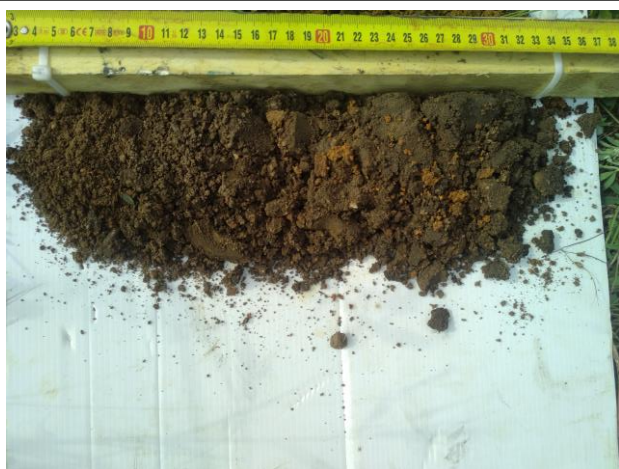
Photographie des prélèvements à la tarière T1 (faciès de limons sablonneux fins à présence de briques)
