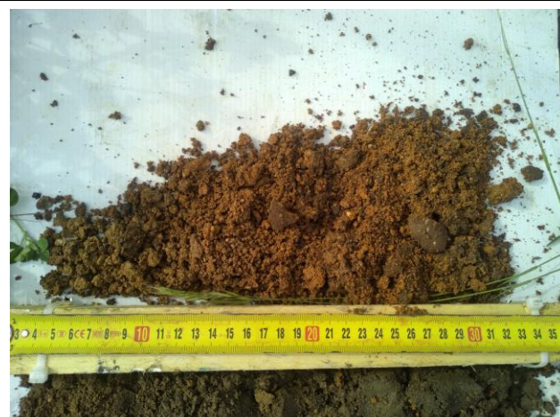
Photographie des prélèvements à la tarière T1 (faciès de sables et graviers ocres)
