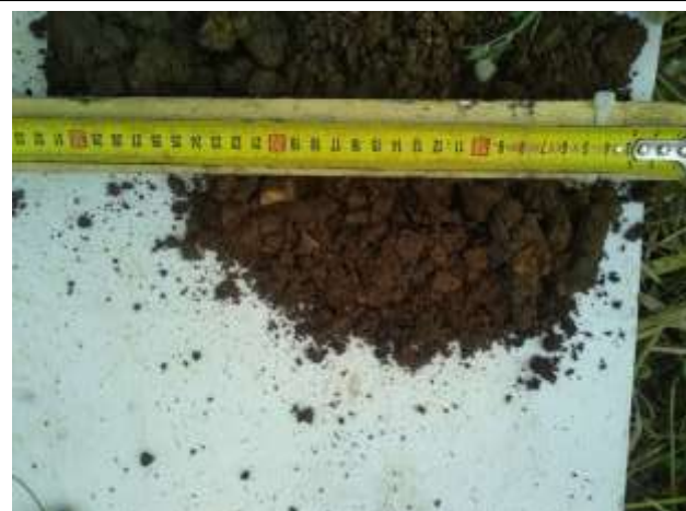
Photographie des prélèvements à la tarière T2 (faciès de limons sablonneux fins à présence de briques)
