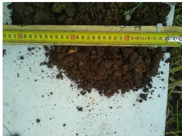
Photographie des prélèvements à la tarière T2 (faciès de limons sabloneux fins à présence de briques)
