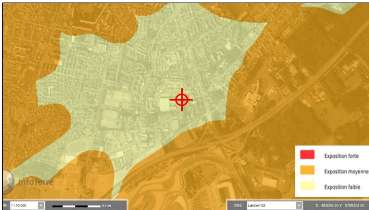
Figure 5 : Cartographie de l'aléa Retrait-Gonflement des Argiles sur le secteur étudié, échelle 1/10 000 (source BRGM)
