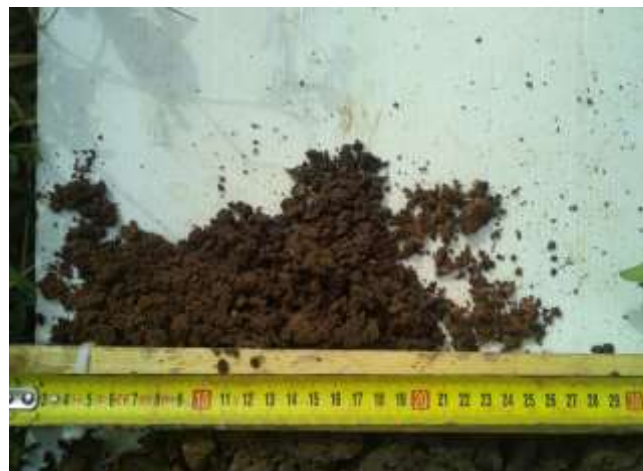
Photographie des prélèvements à la tarière T3 (faciès d'argiles sablonneuses et de sables et graviers)
