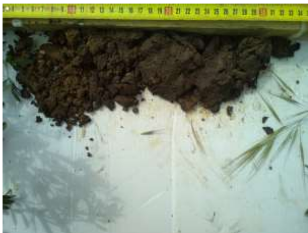
Photographie des prélèvements à la tarière T3 (faciès de sables et graviers et d'argiles sablonneuses)
