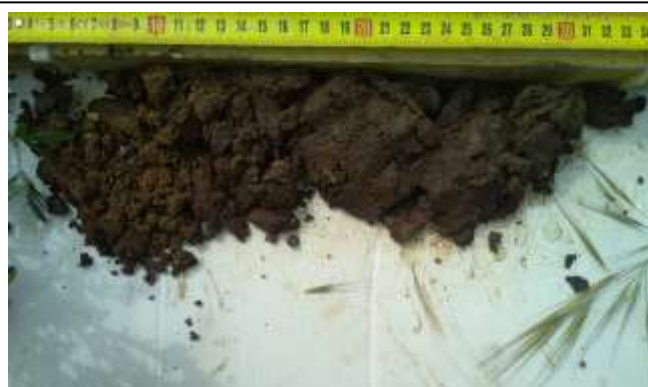
Photographie des prélèvements à la tarière T3 (faciès de sables et graviers et argiles sablonneuses)
