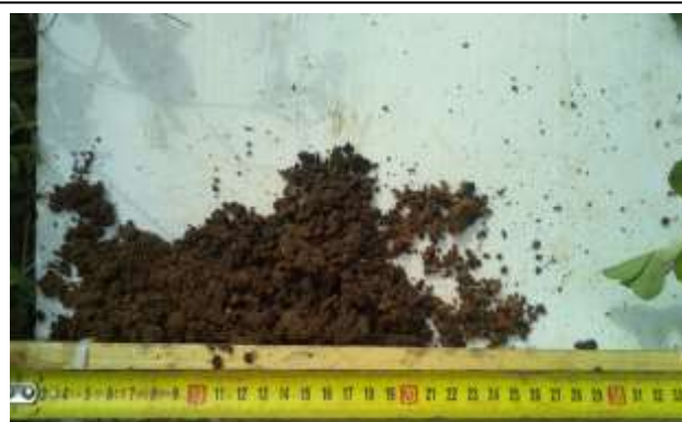
Photographie des prélèvements à la tarière T3 (faciès d'argiles sablonneuses et de sables et graviers)
